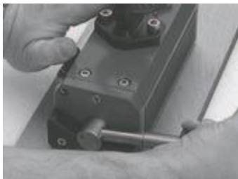
Der Heber befindet sich in der Position "AUS" ("OFF")
