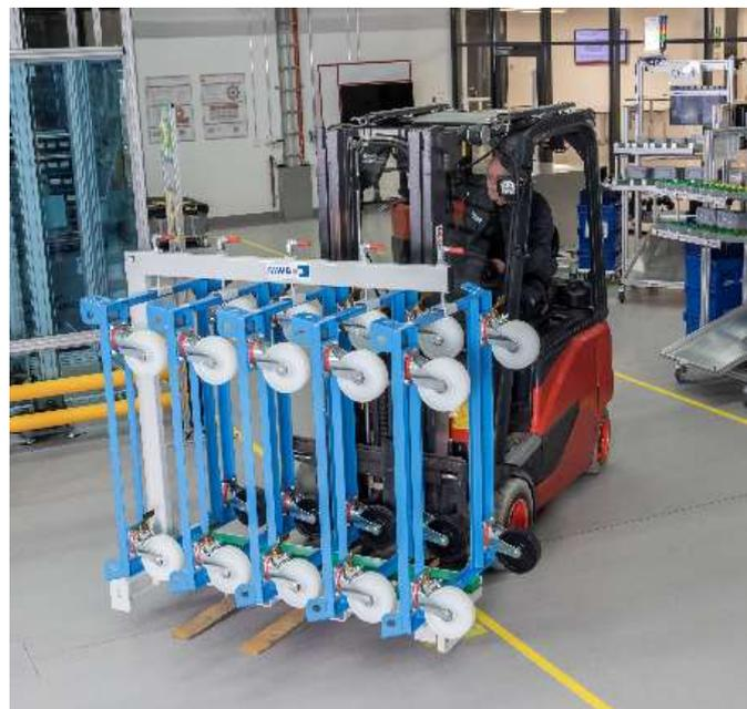
Sicherer Transport mit Stapler durch seitliche Staplerschuhe
