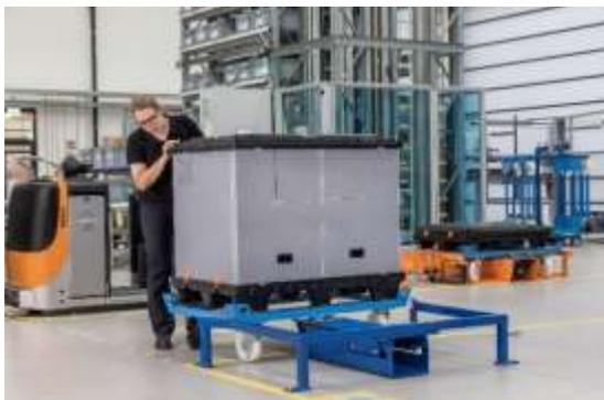
Einfaches Einschieben des Trolleys dank der Einführschräge und des Rahmens im Sichtbereich
