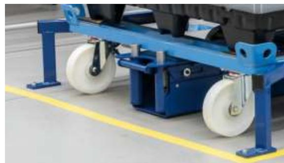
Intuitive Bedienung durch automatische Verriegelung. Lösen der Verriegelung erfolgt ergonomisch durch Treten des Fußpedals
