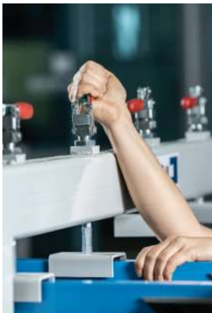
Klemmung der Trolleys mit leichtgängiger Betätigung des Spannhebels
