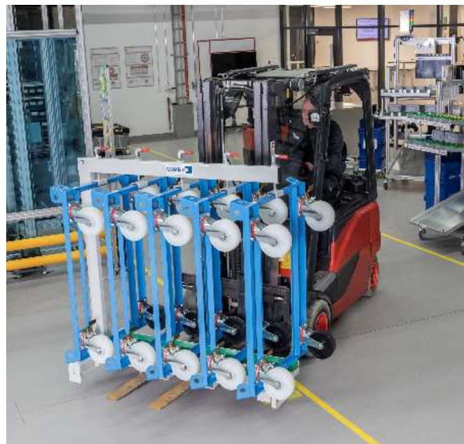
Sicherer Transport mit Stapler durch seitliche Staplerschuhe
