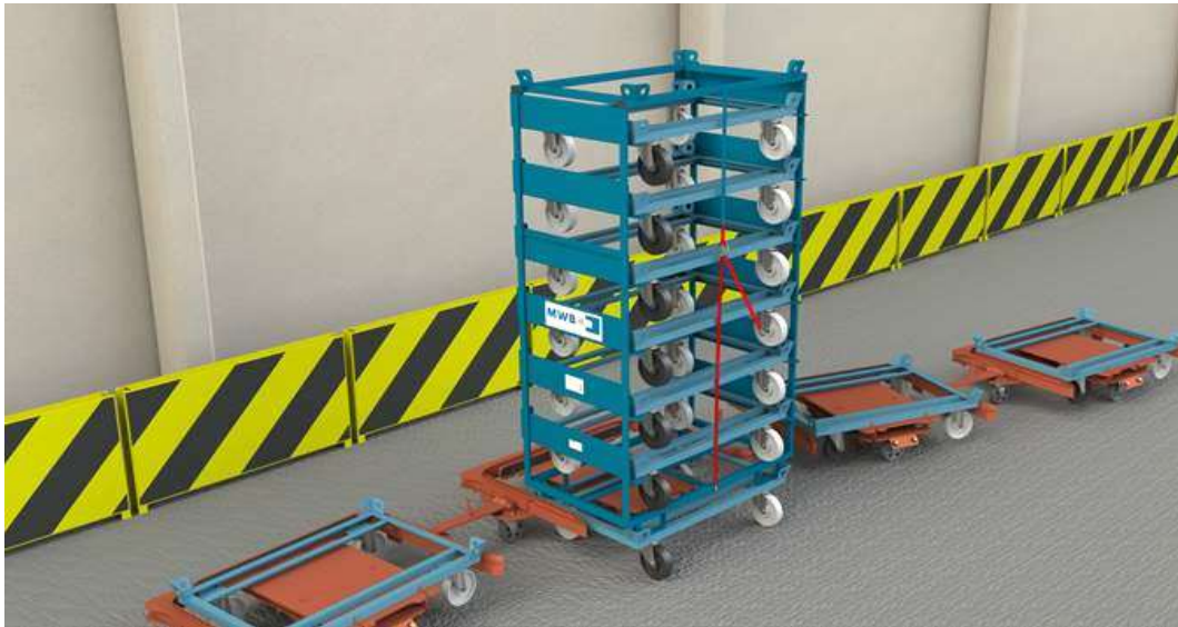
Das Trolleyrack passt auf einen Trolley und kann damit optimal in den Routenzugprozess eingliedert werden
